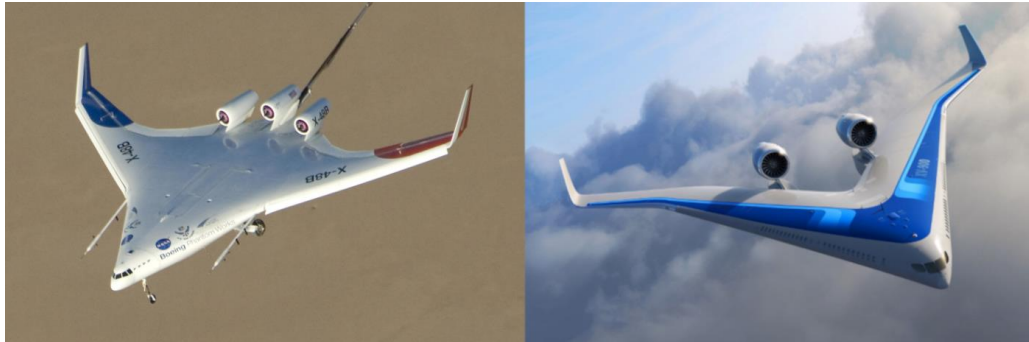
Gambar 3-2: Konfigurasi Pesawat BWB [36] & Flying V[37]
